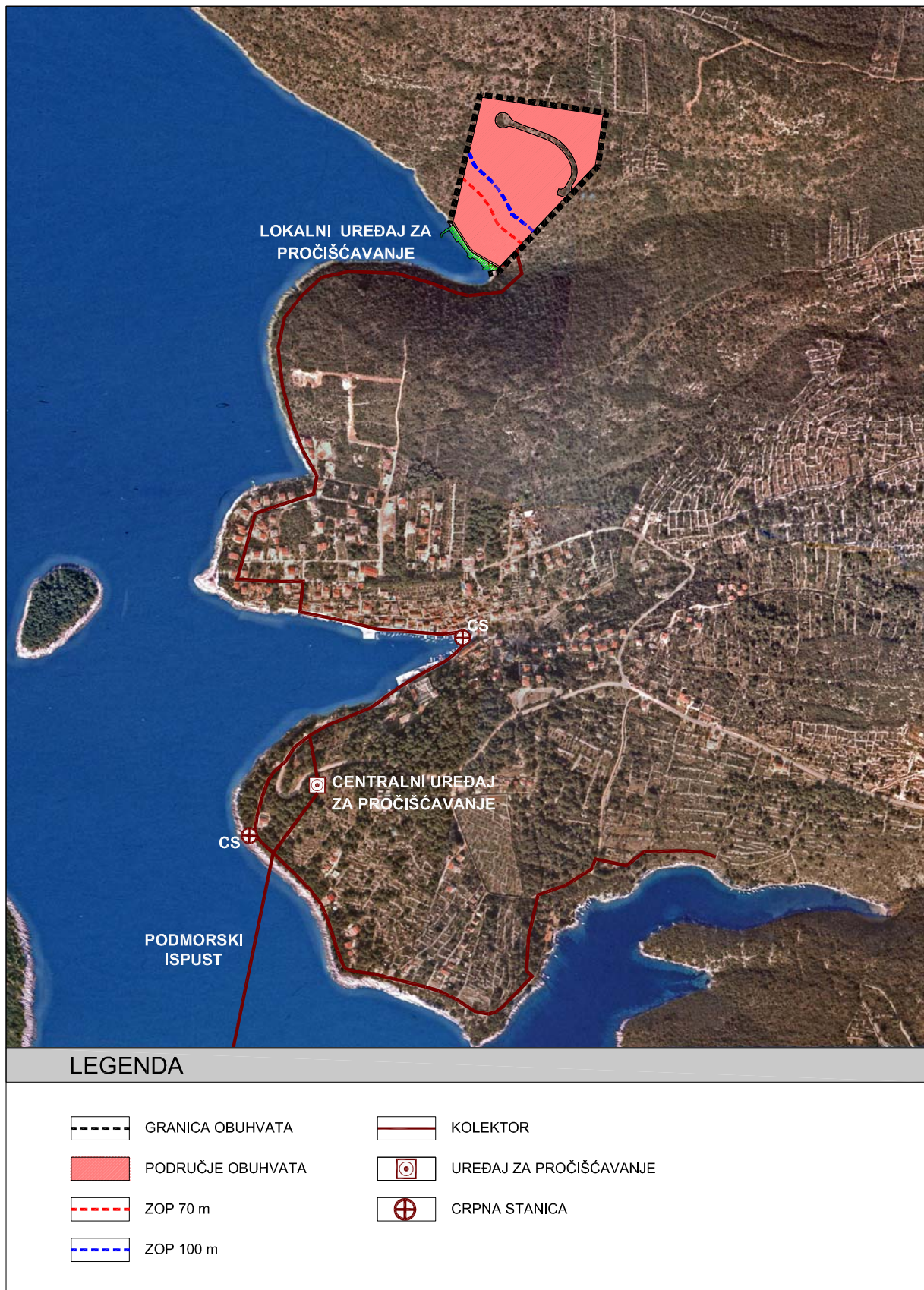
SLIKA 13 Planirani sustav odvodnje
