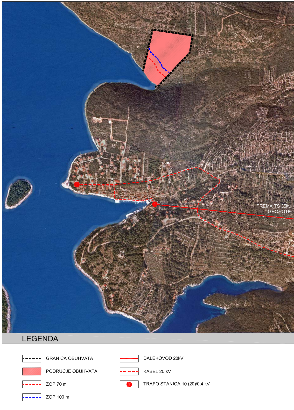
SLIKA 9 Postojeća elektroopskrbna mreža
