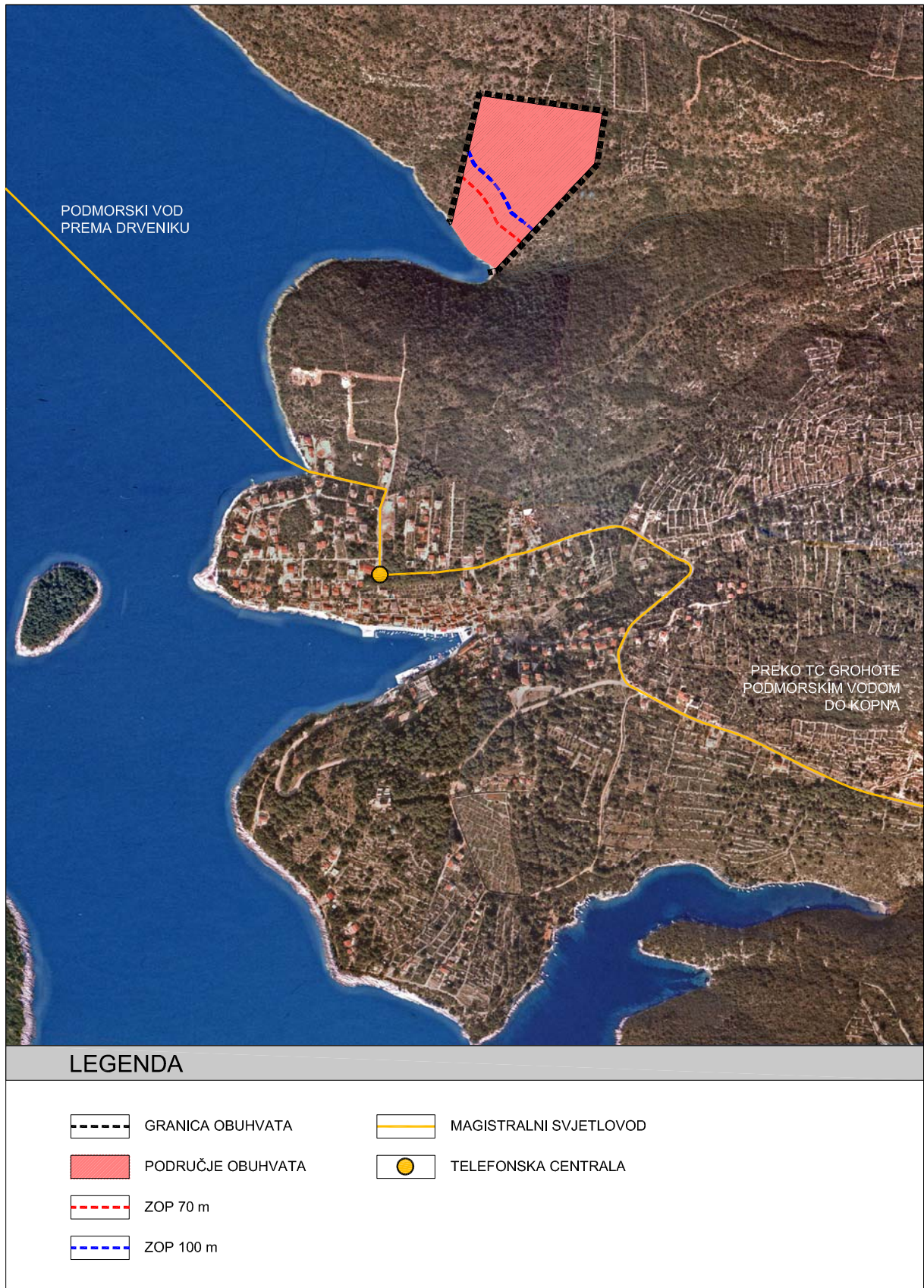
SLIKA 10 Postojeća telekomunikacijska infrastruktura
