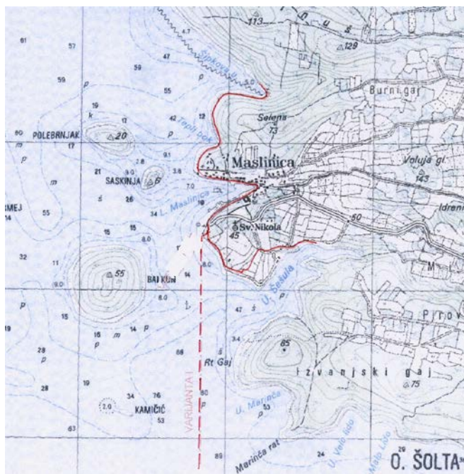
Slika 10. Pregledna situacija kanalizacijskog sustava naselja Maslinica na Šolti, mj. 1:25000 Idejno rješenje, T.D. 186-01/02 (Akvaprojekt d.o.o. Split, 2003. god)
