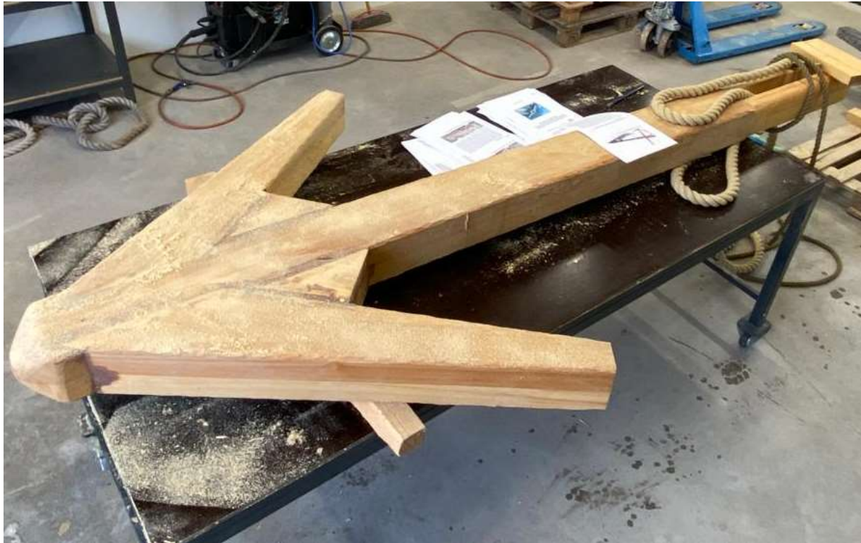
Slika 19. Brušenje zapunjenih spojeva
