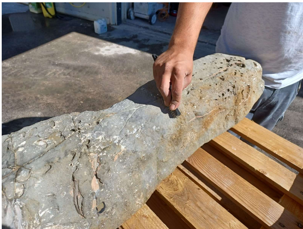
Slika 13./14. Pranje kamena vodom / mehaničko čišćenje
